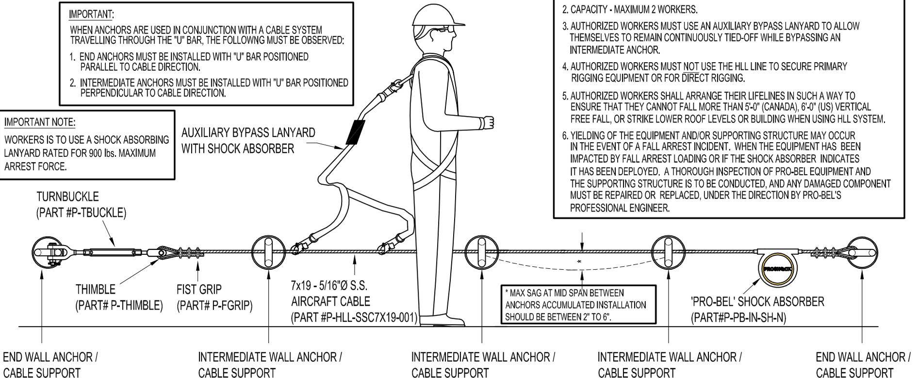
**HORIZONTAL LIFELINE FALL ARREST SYSTEM ASSEMBLY - NON-HANDS FREE (DOUBLE LANYARD) SYSTEM - PRO-SHOCK**
