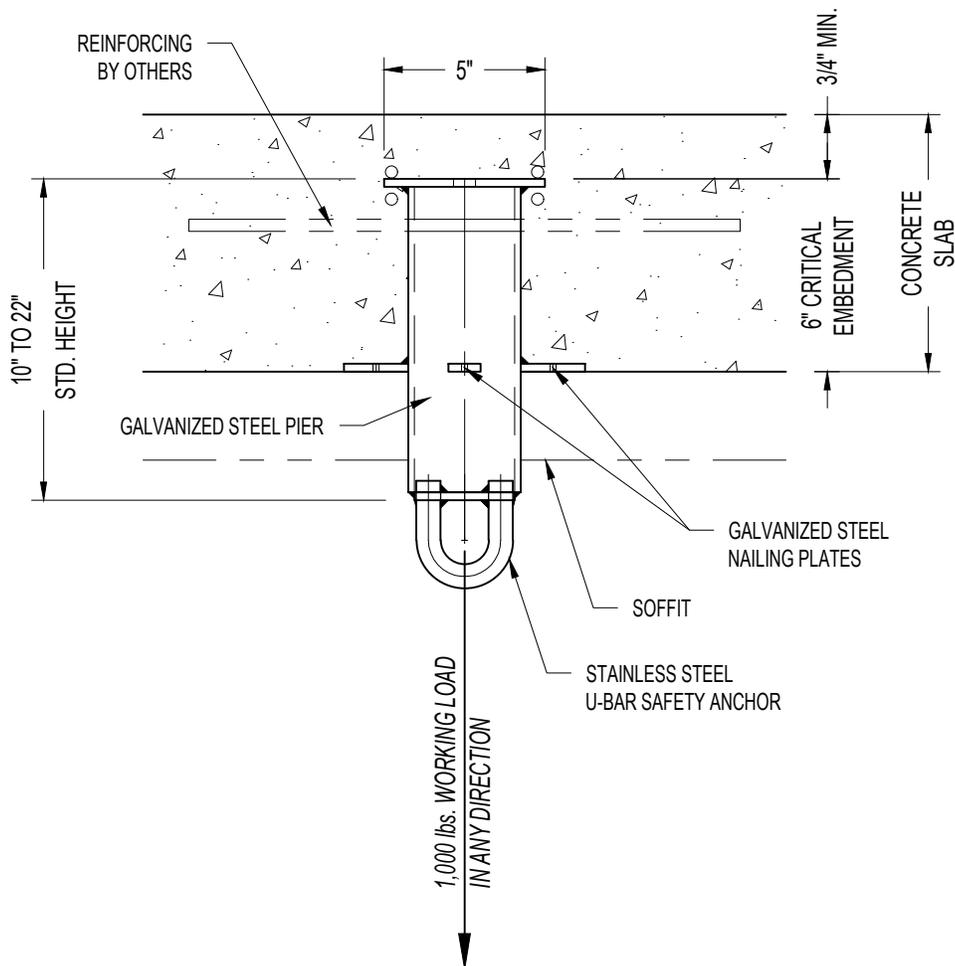
**PBE74EBDNP: CAST IN FULLY EMBEDDED SOFFIT ANCHOR**
