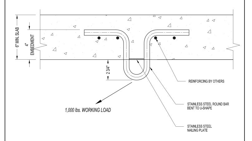
PB70RS: CAST IN U-SHAPE SOFFIT ANCHOR
